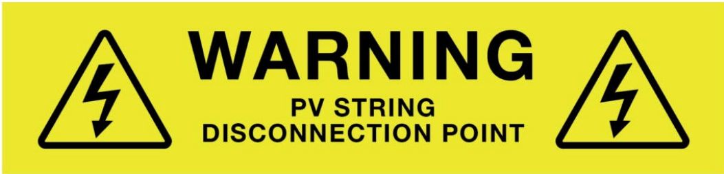
Figure 11. PV String disconnection point sign: See Appendix A4 (d) in AS/NZS 5033:2021
