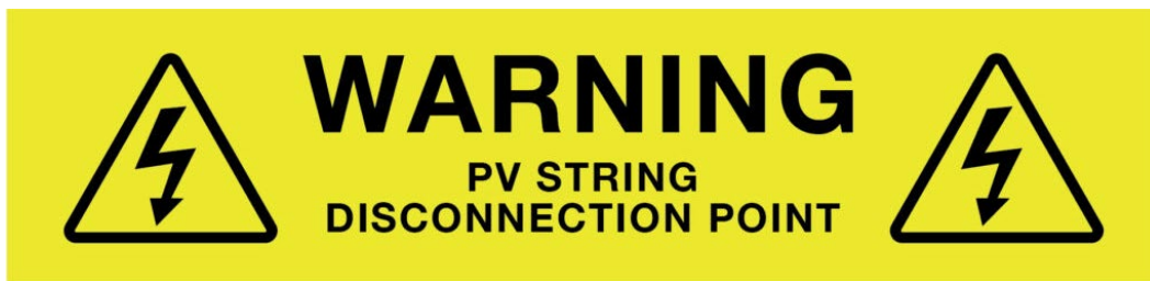
Figure 11. PV String disconnection point sign: See Appendix A4 (d) in AS/NZS 5033:2021
